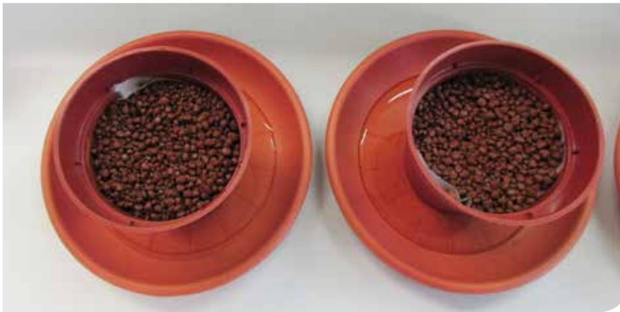
▲ Eerste labotesten op het PCS met IOCS-korrels als voorbereiding van de containerproef.
