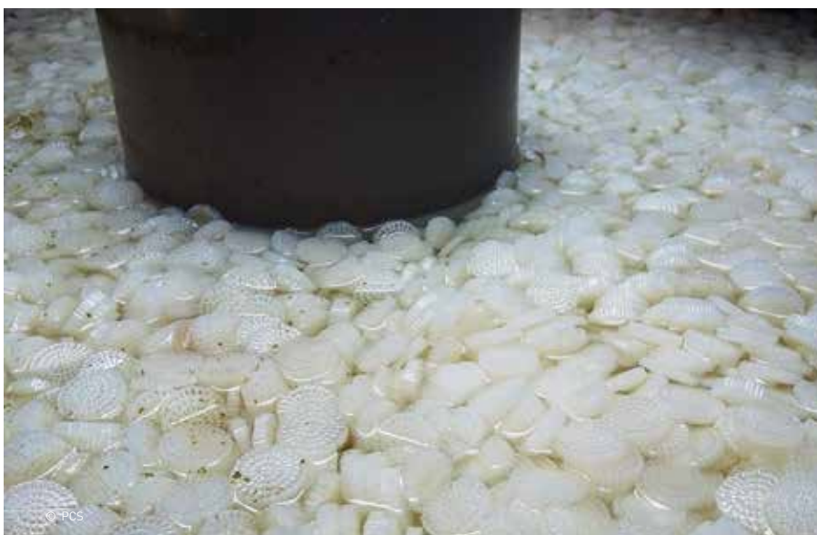
Dragermateriaal binnenin de MBBR
