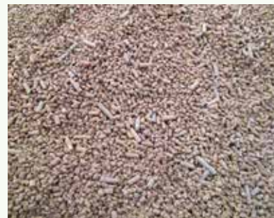
Pellets van steekvast ijzerslib gebruikt als filtermateriaal voor fosfor
