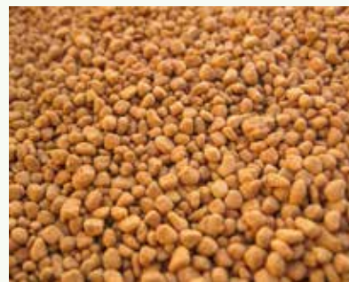
ICS-korrels gebruikt als filtermateriaal voor fosfor
